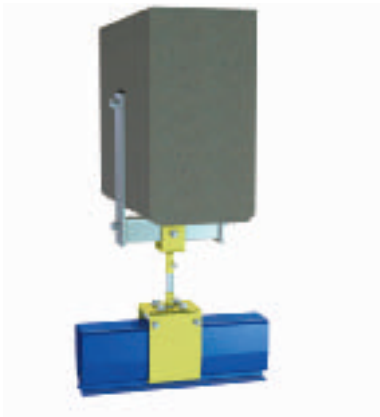
1. L'équerre pour balancier en béton tient le tube carré en acier, qui est le point de soutien pour une suspension en U.
