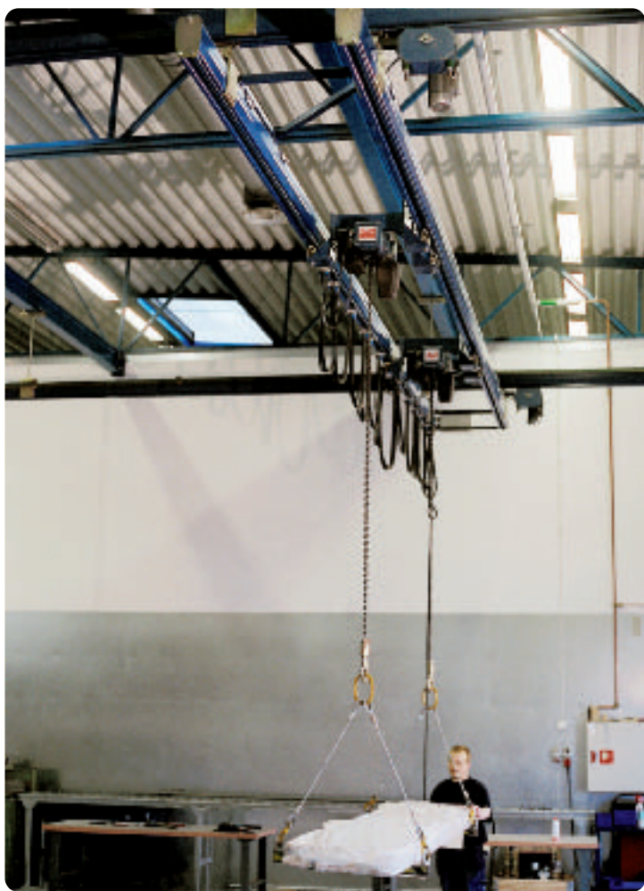
L'industrie sidérurgique utilise le palan à 2 poutres jumelées Lyftman avec des chariots motorisés.
