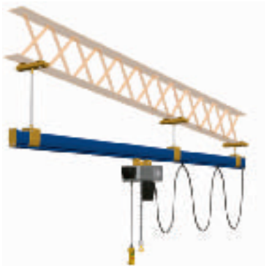
Un système monorail en acier (LR120/170) avec des suspensions par crapotage.
