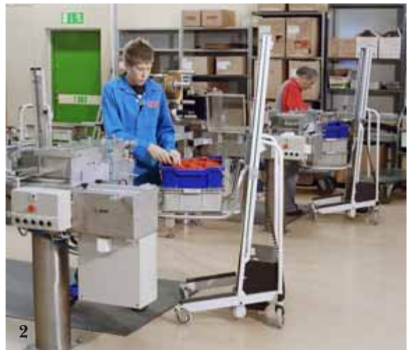
2. Ces PRO100 sont utilisés comme tables de travail mobiles sur cette ligne de montage.
