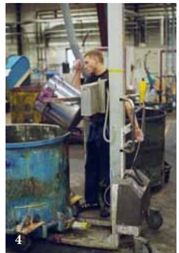
4. Le chariot à haute capacité PRO200 équipé du système EasySqueeze avec retournement manuel.
