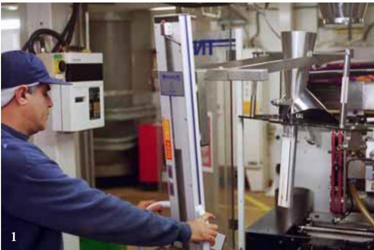
3. Exemple de système de retournement manuel de bac. PRO70.
