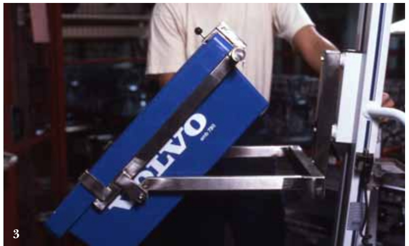
3. Exemple de système de retournement manuel de bac. PRO70.
