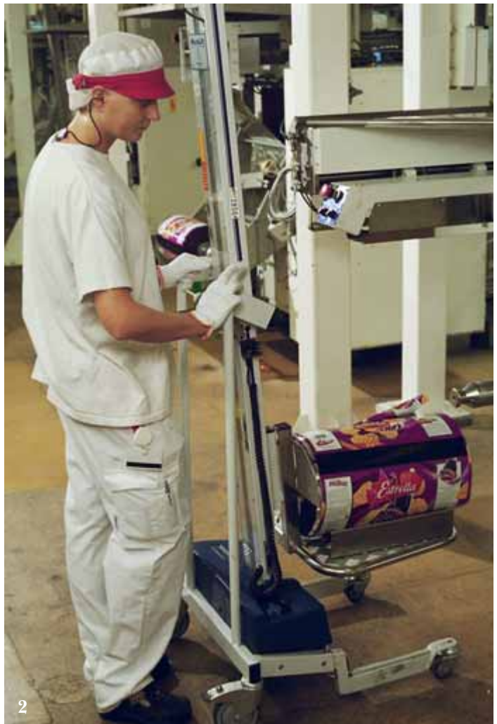
1– 2. Le chargement de bobines sur une emballeuse est effectué sans effort et en toute sécurité avec un V-block (photo de droite) ou un mandrin (photo au dessus). Le V-block est amovible et permet ainsi l'utilisation du plateau pour d'autres types de manutentions entre deux chargements de bobines.
